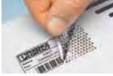
EMLS... Soyulduğunda, metalik tabakanın bir kısmı ayrılır, geride hem etikette hem de yüzeyde üggen bir desen bırakır
